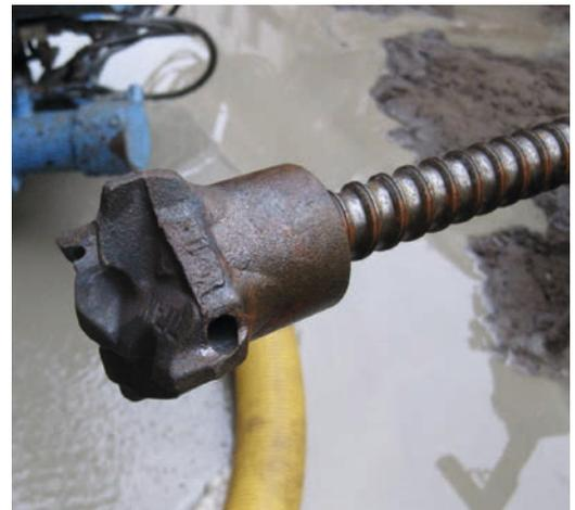
Bild 1: Kreuzbohrkrone Titan 30/11
